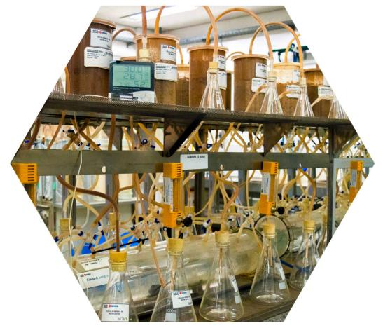
Teste usado para estudos de intemperismo acelerado e também para avaliação de potencial de geração ácida de determinado material.
