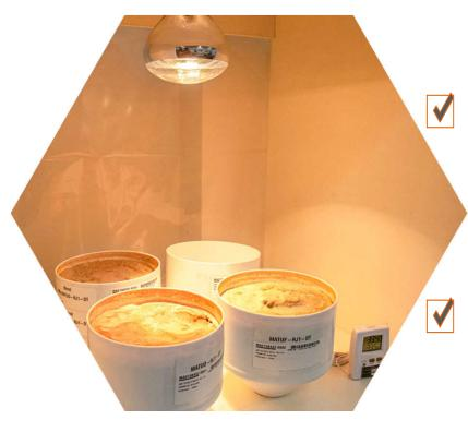
Teste usado para estudos de intemperismo acelerado e também para avaliação de potencial de geração ácida do material
