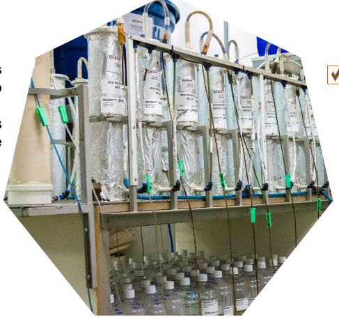
Permite simular as condições naturais do ambiente e disposição do material, porém de forma acelerada.
