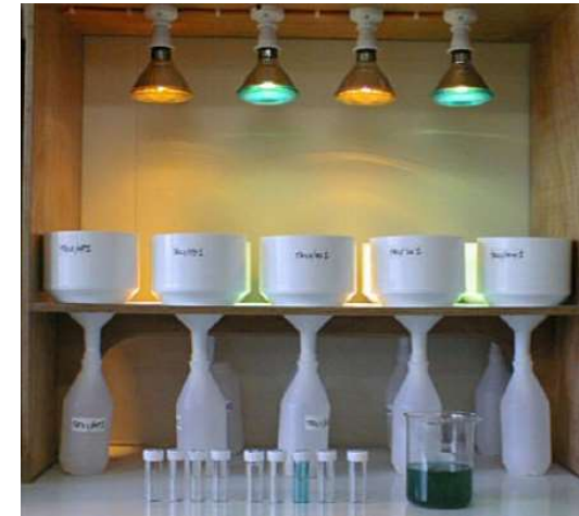
Figura 7: Experimento de free leaching (PAC, 2019).
